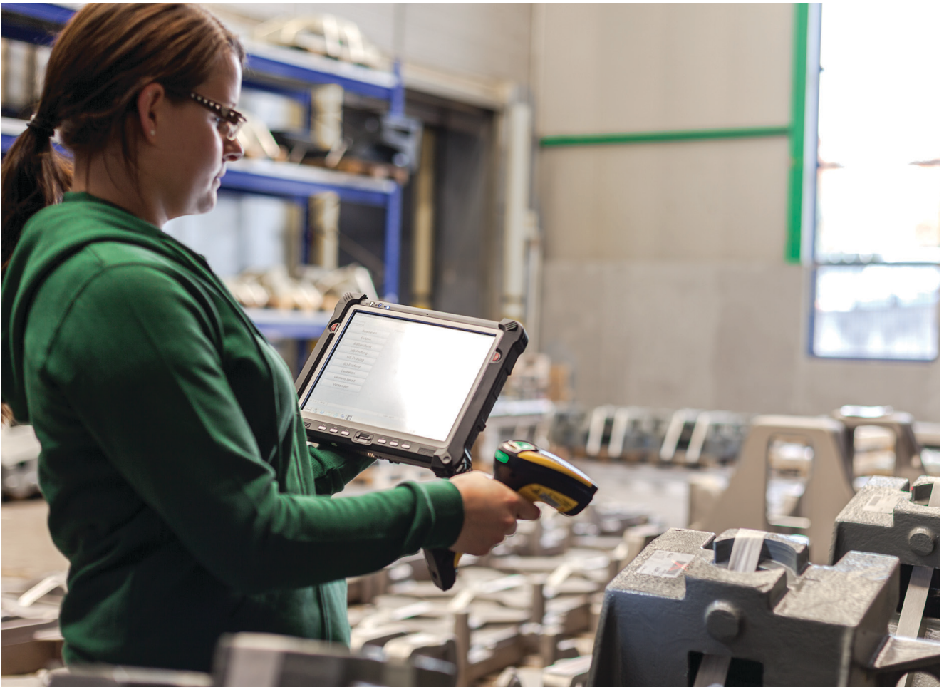
Bild 4: Die neue mobile Versandabwicklung bei Casper zeigt die Zuordnung fertig verpackter und mit Barcode etikettierter Gussteile beim Verladeprozess.
