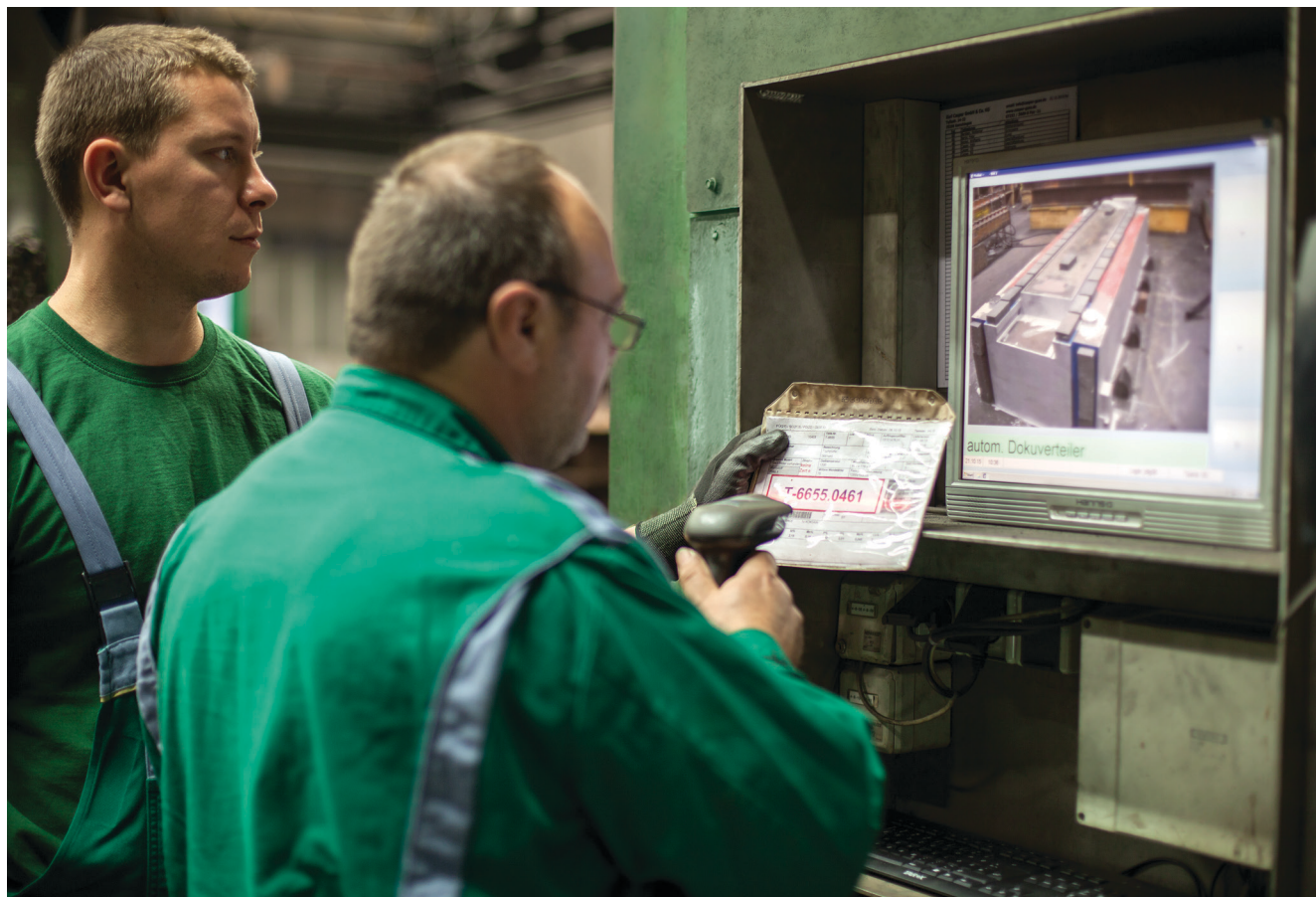
Bild 3: Das Infosystem zeigt aktuelle Fertigungsinformationen und Arbeitsanweisungen zu Beginn jeder Arbeit.
